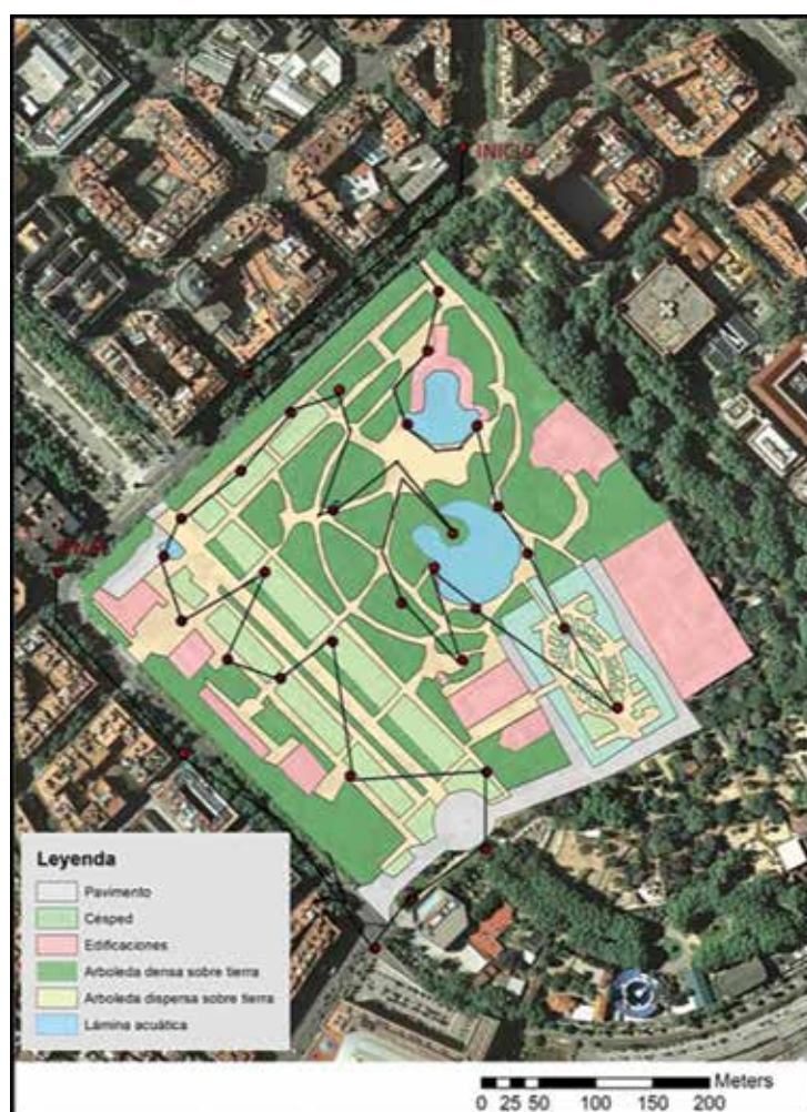
Figure 2. Surface types of Ciutadella Park and transect with measurements points (Source: Cartographic base ©Institut Cartogràfic i Geològic de Catalunya).
